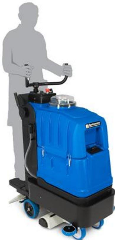
**Nikita-Mini** est un nettoyeur moquette autoporté, idéal pour des surfaces moyennes et grandes de moquette, qui permet de nettoyer jusqu'à 600 m<sup>2</sup> de moquette en une heure. En un seul passage, une bande de 50 cm de moquette est pulvérisée avec une solution concentrée de produit chimique, brossée par une brosse cylindrique, rincée et aspirée.
